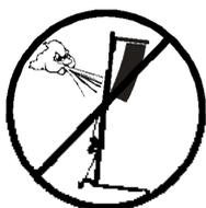
**3.7** - Si existe la posibilidad de vientos fuertes o ráfagas, coloque el elevador en el suelo con firmeza y fijelo mediante tirantes tensores. Nunca fije un tirante a un vehículo o cualquier otro objeto que se pueda mover.
