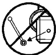
**3.16** - Niemals die Winde, oder Teile der Winde unter Belastung demontieren.
