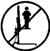
**3.1** - La torre elevadora TL-075 / TL-078 es una má-quina diseñada para la elevación de cargas en dirección vertical. NUNCA se debe utilizar como plataforma elea-vadora de personas.
