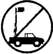
**3.6** - Es ist nicht gestattet den Lift auf einem Fahrzeug mit einen mobilen Unterbau zu installieren!
