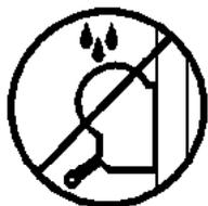
**3.14**- Ölen oder Fetten der Fallbremsen ist zu unterlassen, da diese mit einem Druck und Hitzebeständigen Material bearbeitet wurden. Andere Werkstoffe führen in der Handhabung zu negativen Effekten.
