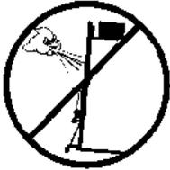
**3.7** - Bei Freiluftanwendungen den Turm auf festen Boden stellen und mittels Seilanker gegen Windbelastung sichern. Niemals an Fahrzeugen die Abspannungen befestigen oder an Gegenständen, die ausweichen könnten.
