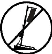
**3.2** - Colocar el elevador sólo en superficies firmes y planas, verificando que está en posición vertical, utili-zando el indicador de nivel de burbuja (L) que se en-cuentra en la base. Ajuste los estabilizadores (Q) gi-rando las manivelas (H) hasta nivelar, si es necesario. Nunca utilice cuñas u otros objetos extraños para equi-librar el elevador.
