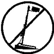
**3.2** - Achten Sie darauf, dass der TL-075 / TL-078 Tower auf festem, geraden Untergrund steht. Und vergewissern Sie sich mit Hilfe der Wasserwaage (F), dass er eine vertikale Position zum Boden eingenommen hat. Bei Bedarf mittels des Stelltellers (Q) durch Drehen der Spindelkurbel (H) die entsprechende Tunlage einstellen.
