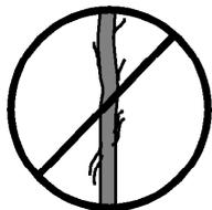
**3.12** - Vor Gebrauch Seilzustand kontrollieren. Das Seil darf keine Seilbrüche oder Quetschungen aufweisen. Es dürfen auf keinem Fall Seile in einem schlechten Zustand verwendet werden.
