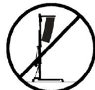
**3.4** - Este elevador NUNCA debe utilizarse para elevar una carga que no ha sido correctamente revisada. Es necesario verificar que la carga está correctamente apoyada y centrada en el soporte de elevación apropiado para que el peso de la carga sólo actúe en una dirección vertical.
