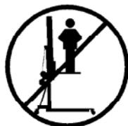
**3.1** - La torre elevadora TE-071 es una máquina diseñada para la elevación de cargas en dirección vertical. NUNCA se debe utilizar como plataforma eleavadora de personas.
