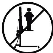
**3.1 -** La torre elevadora TL-A150 es una máquina diseñada para la elevación de cargas en dirección vertical. **NUNCA** se debe utilizar como plataforma eleavadora de personas.
