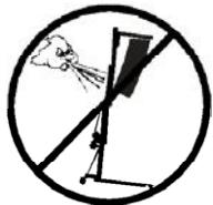
3.7 - Si existe la posibilidad de vientos fuertes o ráfagas, coloque el elevador en el suelo con firmeza y fíjelo mediante tirantes tensores. Nunca fije un tirante a un vehículo o cualquier otro objeto que se pueda mover.
