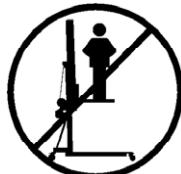
**3.1** - La torre elevadora TE-086 es una máquina diseñada para la elevación de cargas en dirección vertical. NUNCA se debe utilizar como plataforma eleavadora de personas.
