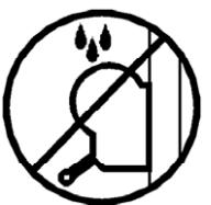
**3.14** - No engrasar ni lubricar el mecanismo de freno del cabestrante. Los discos de freno vienen engrasados con una solución especial resistente a la presión y al calor. No deben utilizarse otros productos, para evitar los efectos negativos sobre el mecanismo de frenado.
