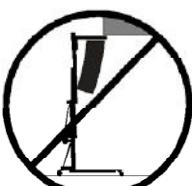
3.10 - Tenga cuidado con todos los obstáculos por encima de la elevación y su zona de extensión, como cornisas, balcones, letreros luminosos, etc. Es muy importante evitar la presencia de todo tipo de cables por debajo de la torre extendida.
