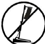
**3.2** - Colocar el elevador sólo en superficies firmes y planas, verificando que está en posición vertical, utilizando el indicador de nivel de burbuja (L) que se encuentra en la base. Ajuste los estabilizadores (Q) girando las manivelas (H) hasta nivelar, si es necesario. Nunca utilice cuñas u otros objetos extraños para equilibrar el elevador.
