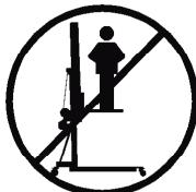
**3.1** - La torre elevadora TE-076 es una máquina diseñada para la elevación de cargas en dirección vertical. NUNCA se debe utilizar como plataforma eleavadora de personas.
