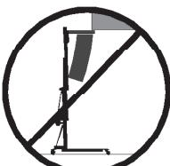
**3.10** - Tenga cuidado con todos los obstáculos por encima de la elevación y su zona de extensión, como cornisas, balcones, letreros luminosos, etc. Es muy importante evitar la presencia de todo tipo de cables por debajo de la torre extendida.
