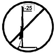
**3.15** - La carga mínima para evitar problemas relacionados con el mecanismo de rotura es 25 kg. Sin esta carga mínima el freno no funcionará.
