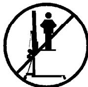
**3.1** - La torre elevadora TE-046 es una máquina diseñada para la elevación de cargas en dirección vertical. NUNCA se debe utilizar como plataforma eleavadora de personas.
