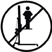
**3.1** - La torre elevadora TE-034 es una máquina diseñada para la elevación de cargas en dirección vertical. NUNCA se debe utilizar como plataforma elevadora de personas.
