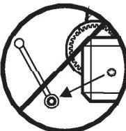
**3.16** - NUNCA desmontar la manivela del cabestrante cuando el elevador está soportando una carga o extendido.
